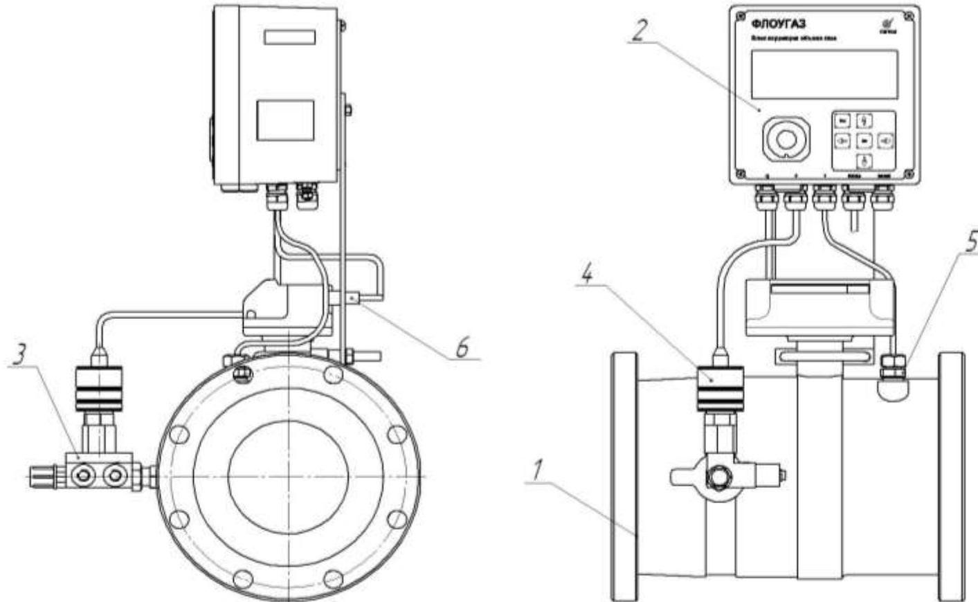
Комплекс КИ-СТГ на базе счетчика СТГ с корректором «Флоугаз»
