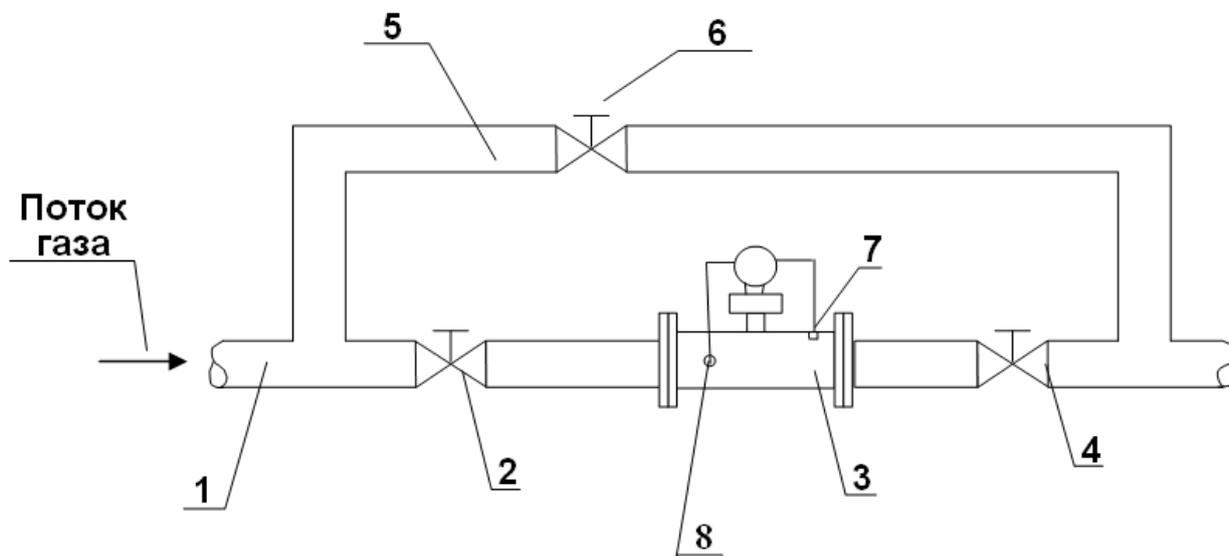
1 - трубопровод; 2, 4 – краны или вентили до и после комплекса;
