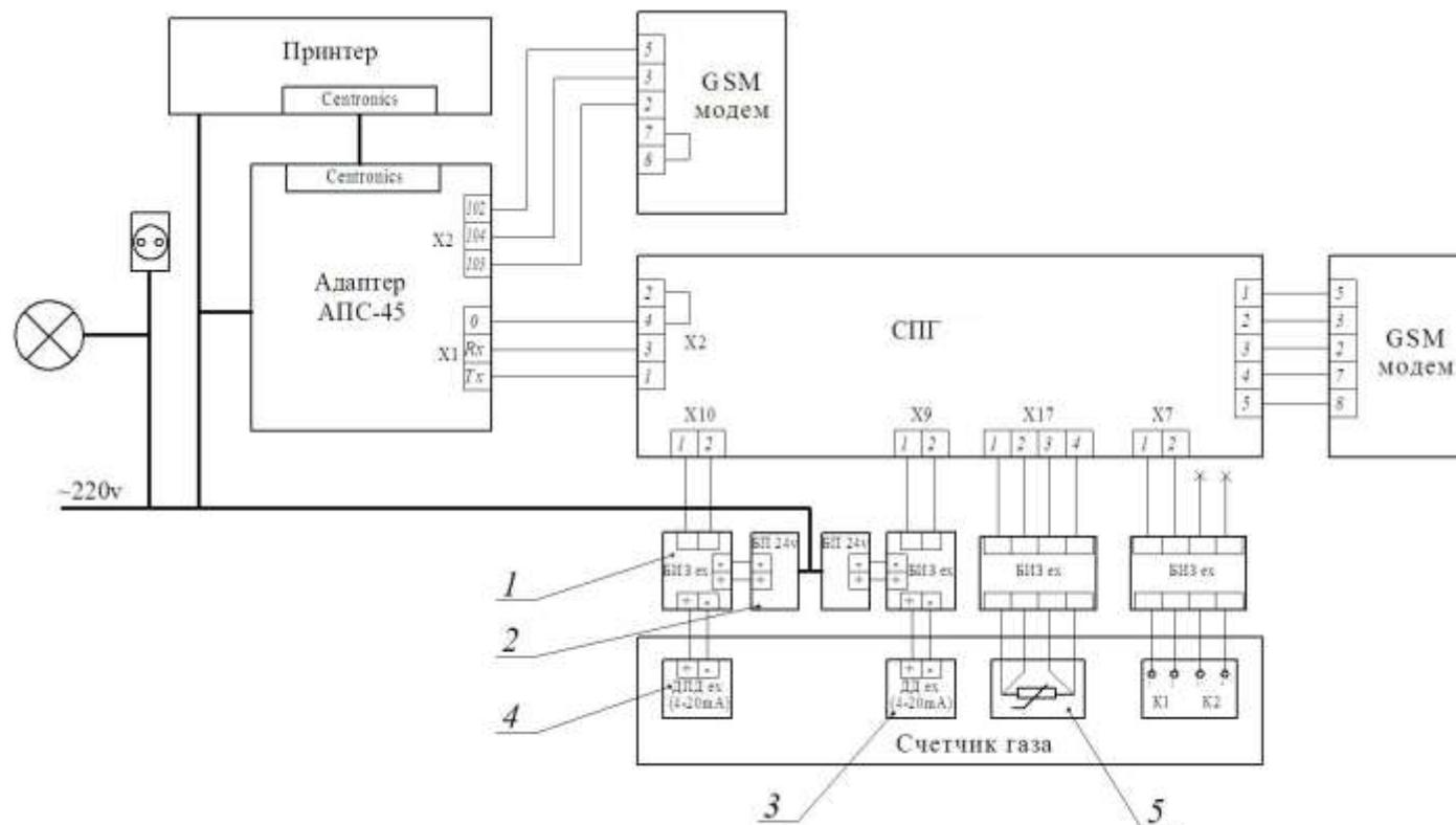
Вариант функциональной схемы подключения внешних устройств при использовании комплекса
