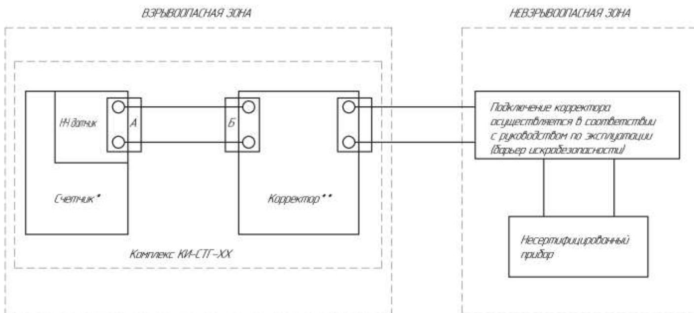
\* - счетчик газа турбинный сертифицирован как 1Ex ib ПА Т6 Gb X; счетчик газа ротационный сертифицирован как 1Ex ib ПА Т6 Gb X;
